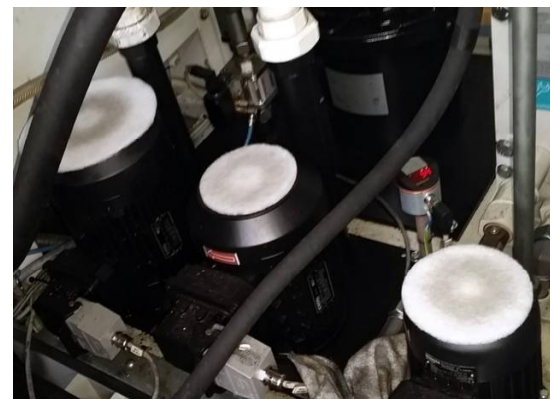
Przykład zastosowania formatki filtracyjnych KS 15/100, G2
